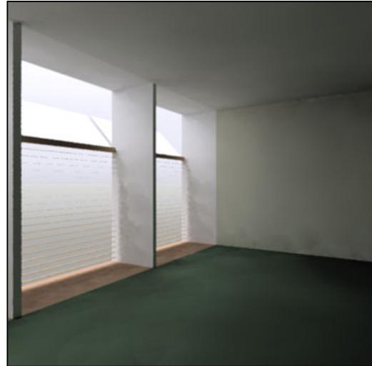
**Fig. 50** *Light shelf* con cielo nublado con película especular de alta reflectancia a 60 grados.
