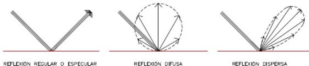
**Fig. 33** Reflexión de los rayos solares según sea el material de la superficie.
