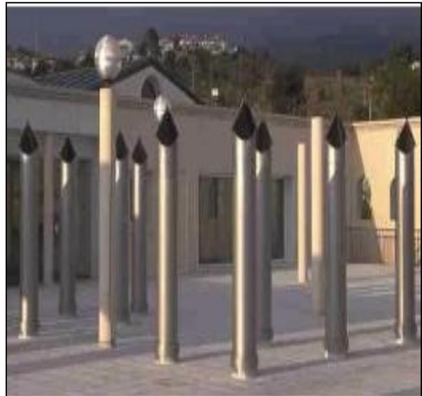
**Fig. 78** Los ductos solares captan y transportan la luz del sol hasta el aula sin ventanas situada bajo la cubierta del edificio.
